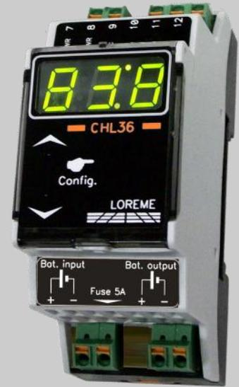
**Le CHL36 est un chargeur de batterie compact, communicant par l'intermédiaire d'un module de tête Ethernet TEH36, permettant la mise en réseau de 32 chargeurs sur une seule liaison Ethernet (protocole Modbus-TCP) par l'intermédiaire du Bus interne. La communication permet le contrôle du courant et de la durée de charge, ainsi que la tension de batterie, en faisant un outil idéal pour la réalisation de banc de charge automatisé.**
